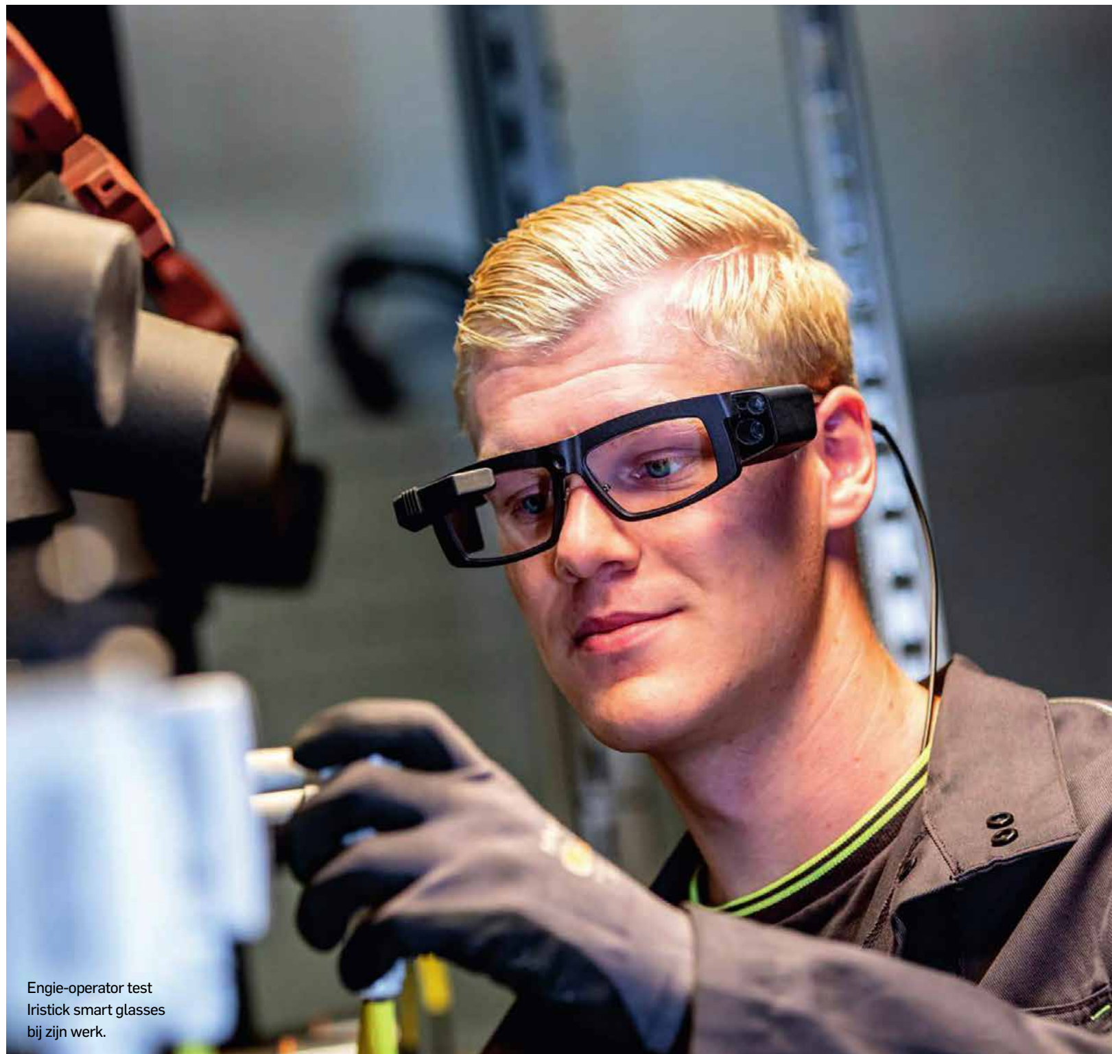
De bril is met een draad verbonden met een smartphone. Zo is alle functionaliteit en rekenkracht beschikbaar zonder extra straling dicht bij het hoofd.
